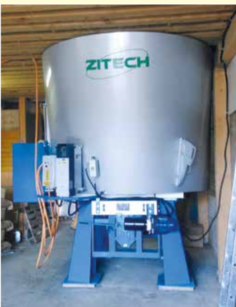
Chopper Stationary V1 und V2 Spezialanfertigungen für Stationär-Futtermischer Frequenzgesteuerter Antrieb über Elektromotor und 2-Gang-Schaltgetriebe
