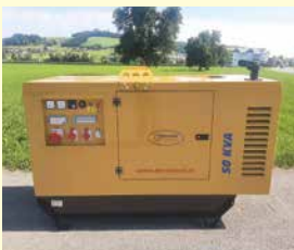
Bertoli Notstromaggregat, Neu, Jg. 2023, 50 kVA, 3-Zylinder FPT Motor, schall- isoliert, AVR geregelt
