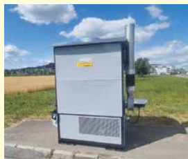
LASCO Stückgut-Warmluft- ofen LA 325, Demo, Jg. 2025, 325kW Heizleis- tung, Rauchgasregelung
