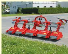
Breviglieri Reihenfräse I07R V.330, Neu, Jg. 2025, 5 Fräselemente à 40–50 cm
