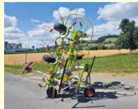
CLAAS Volto 60 Neu, Jg. 2023, Tastrad, 5.80 m Arbeitsbreite
