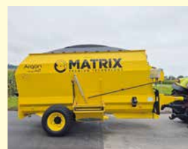
Matrix Argon 12, Neu, 12 m³, Jg. 2026, Waage, Schieber li+re, Band rechts
